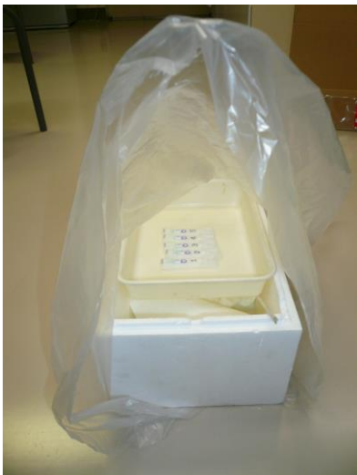
発泡スチロール容器に温湯ペットボトルを入れ加温する。(温度計で確認)
