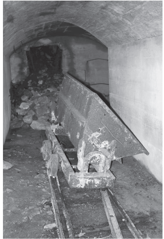
写真9 坑道内のトロッコと石灰石流入口 奥は4m四方の広い空間になっており、奥の壁にあいた穴から石灰石などの土砂が流入していた。
