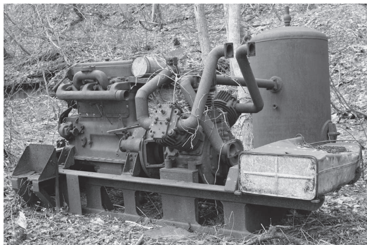
写真1 三菱製ディーゼルエンジン（左）と コンプレッサ（中央）、高圧空気タンク（右奥）
