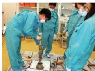
土の締め固め試験(土質実習)
