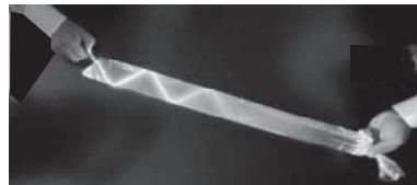
傘袋に蛍光インクを数滴混ぜた水を入れて、光を入射させると、傘袋の中を光が折れ曲がって進むようすが分かる。蛍光インクの代わりに、牛乳や小麦粉などを混ぜても確認できる。
