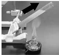
熱せられてピンク色に変わった水が、上に移動していくわ。そして、替わりに上にある温度の低い青色の水が下に移動するのね。つまり、下で熱せられてピンク色になって上に移動するから、ピンク色の温かい部分が増えていくということね。
