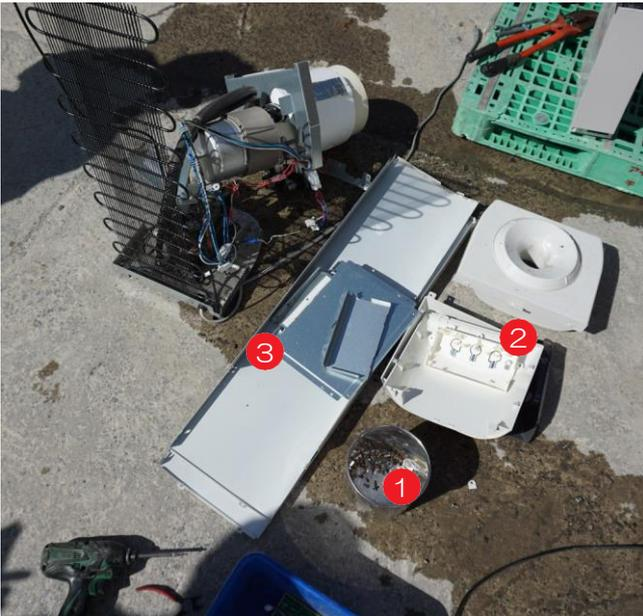
前面のプラスチック製パネルを取りはずします。
