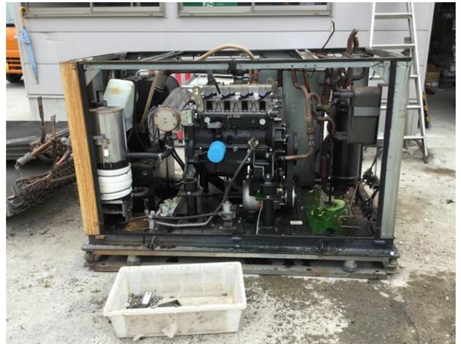
カバーをはずした下部ユニットです。中央にエンジンがあります。下部ユニットは解体せず、このまま**金属類（混入有り鉄材）**として再資源化施設に出荷します。
