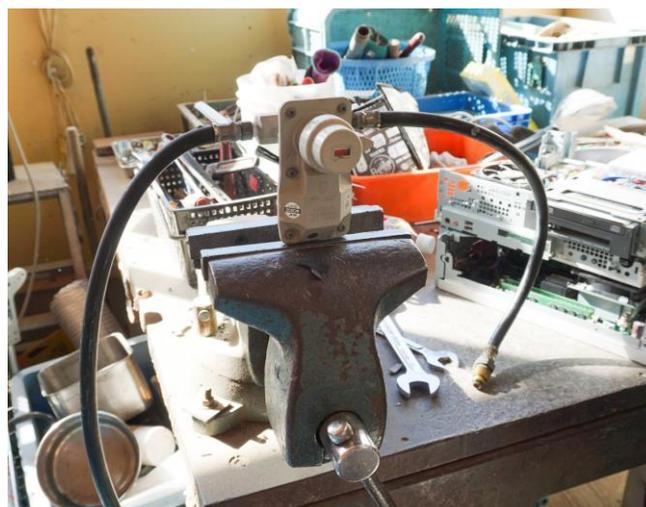
調整器を万力で挟み固定してホースをはすし、調整器を分別します。
