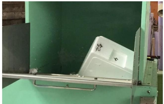
大きいものは、投入口に入る大きさに調整して入れていきます。
