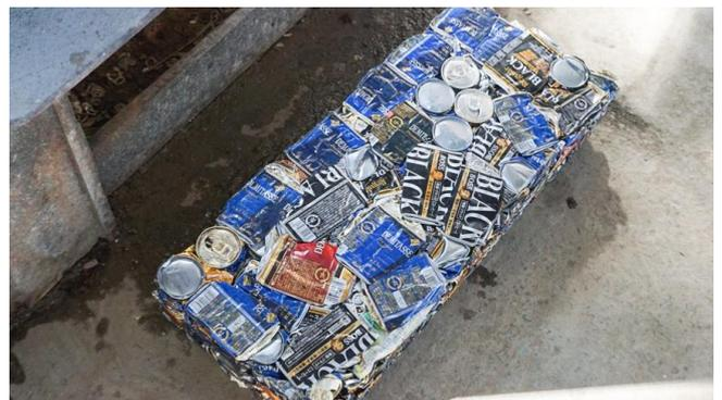
圧縮機（プレス機）から圧縮成形した空き缶のブロックを取り出します。
