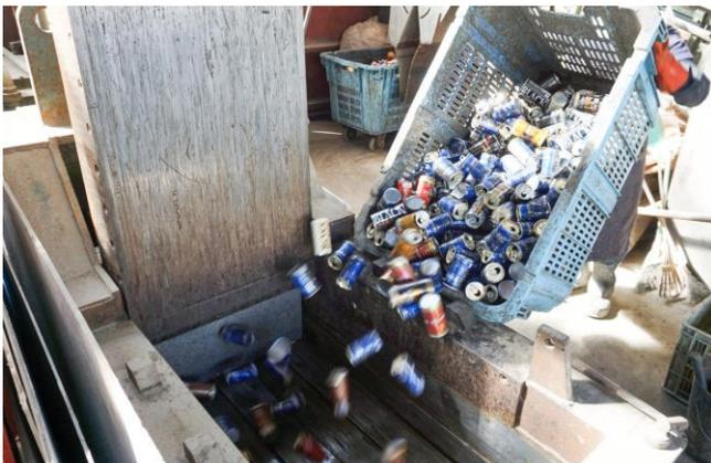
選別された空き缶を圧縮機（プレス機）に投入します。
