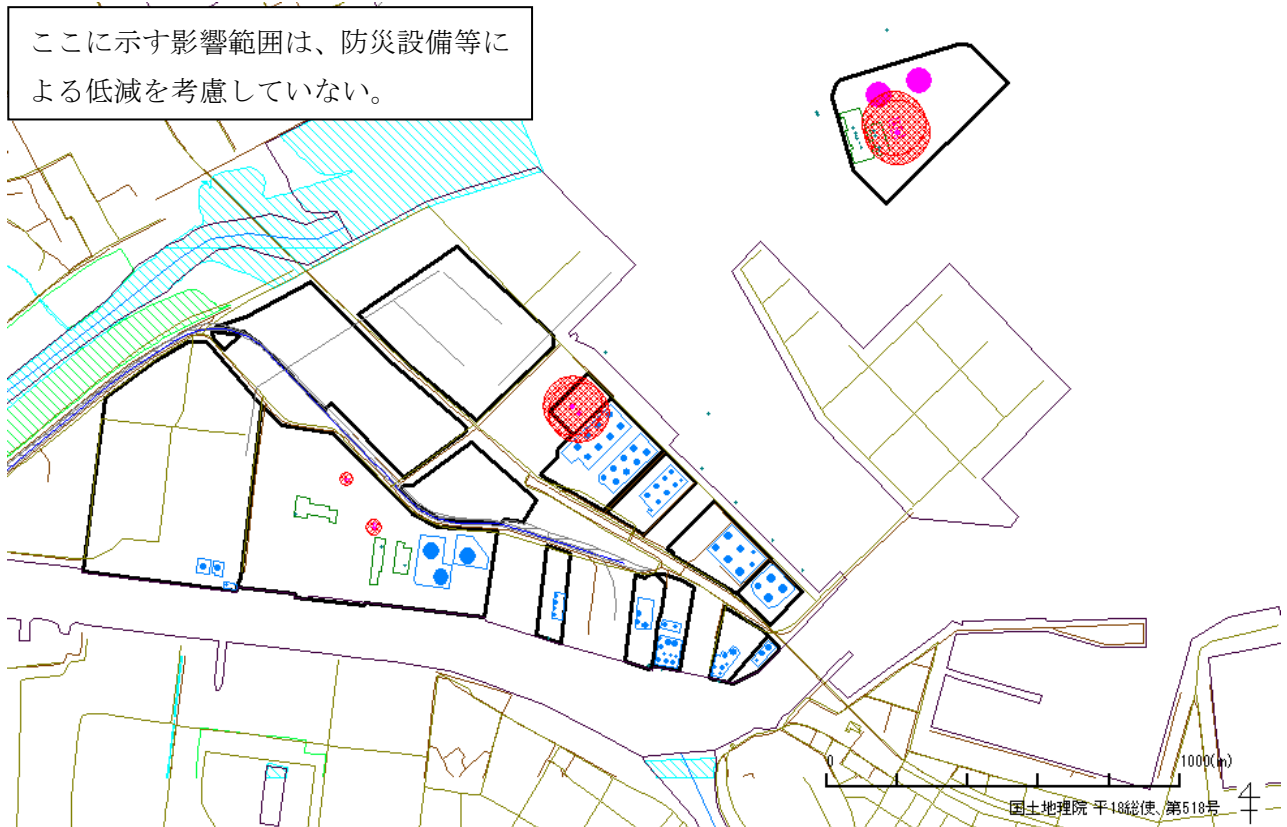
図 2.3.3 八戸地区 ガスタンクの爆発・火災(短周期地震動、発生危険度 A~C レベルの災害)
