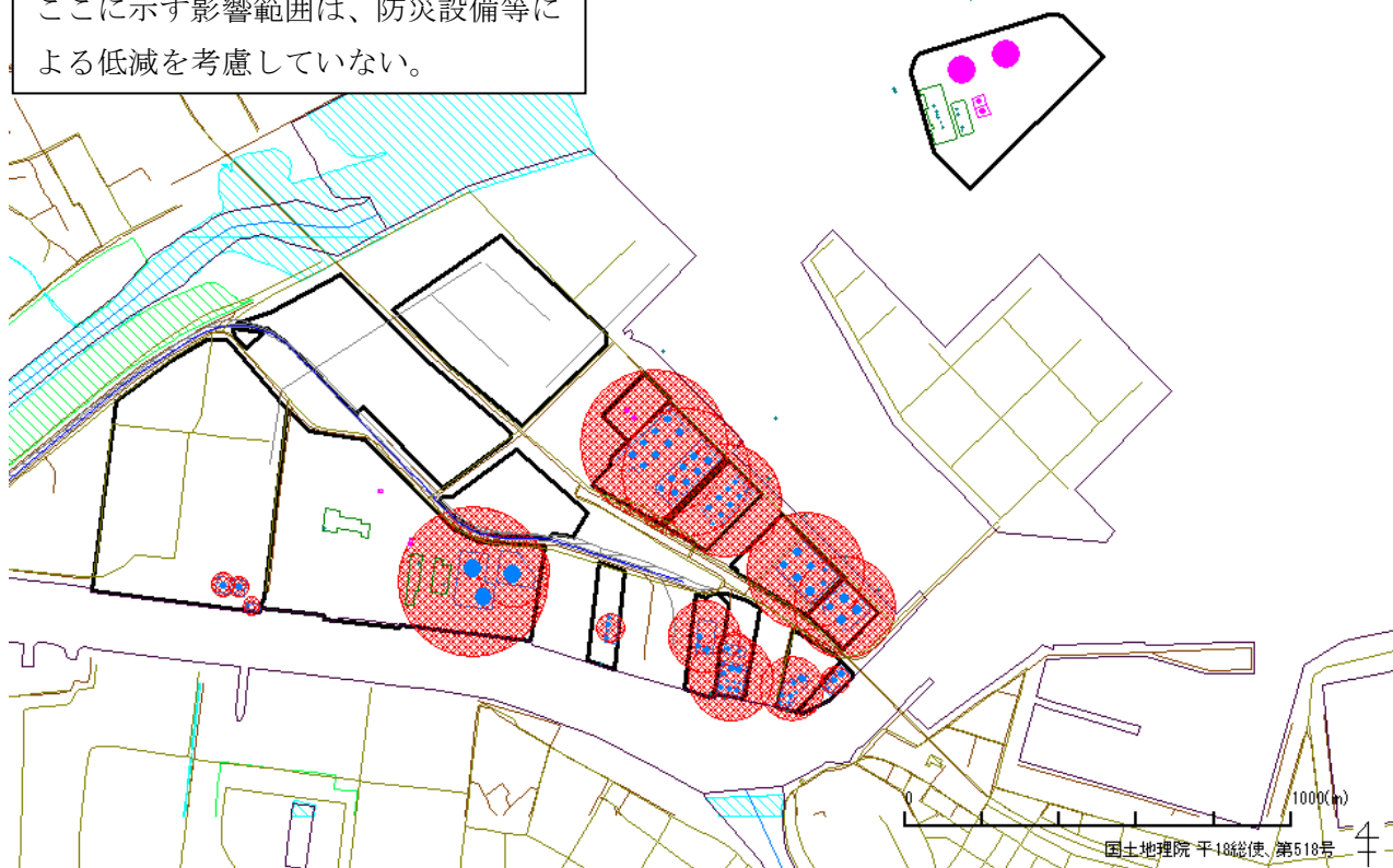
図 4.3.1 八戸地区 危険物タンクの防油堤全面火災
