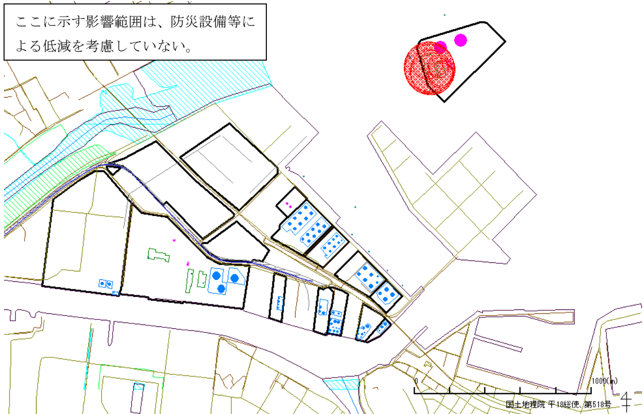
図 2.3.6 八戸地区 製造施設の爆発(短周期地震動、発生危険度 D レベルの災害)
