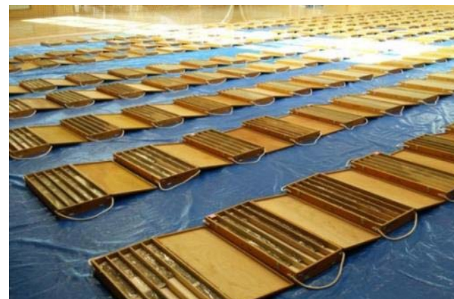
ボーリングで海底から採取した試料を並べた様子(全景)
