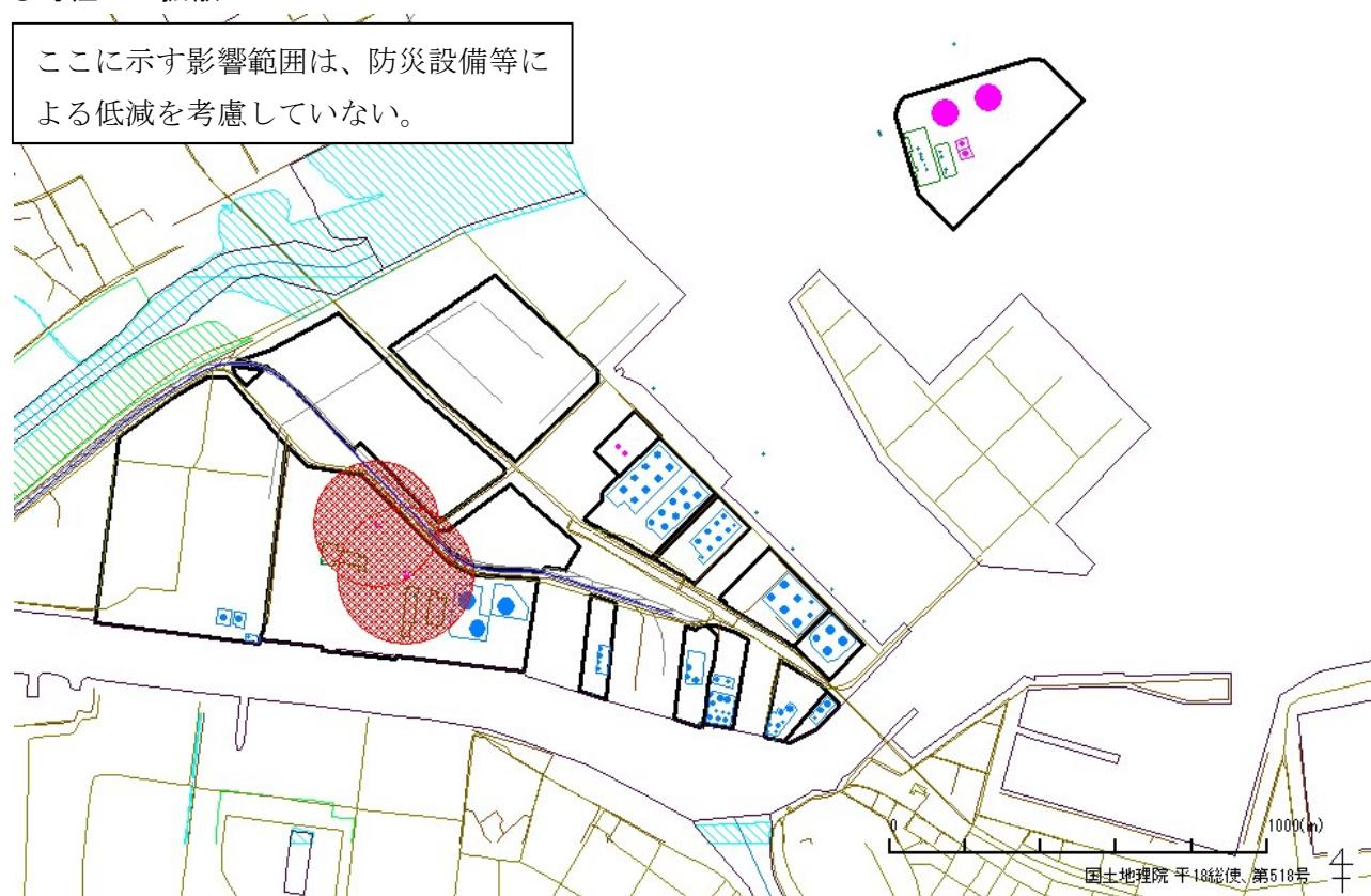
図 1.3.6 八戸地区 ガスタンクの毒性ガス拡散(平常時、発生危険度 A～C レベルの災害)
