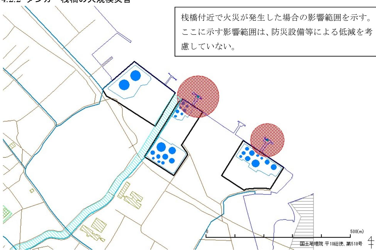
図 4.2.2 青森地区 タンカー桟橋からの危険物の大規模流出による火災
