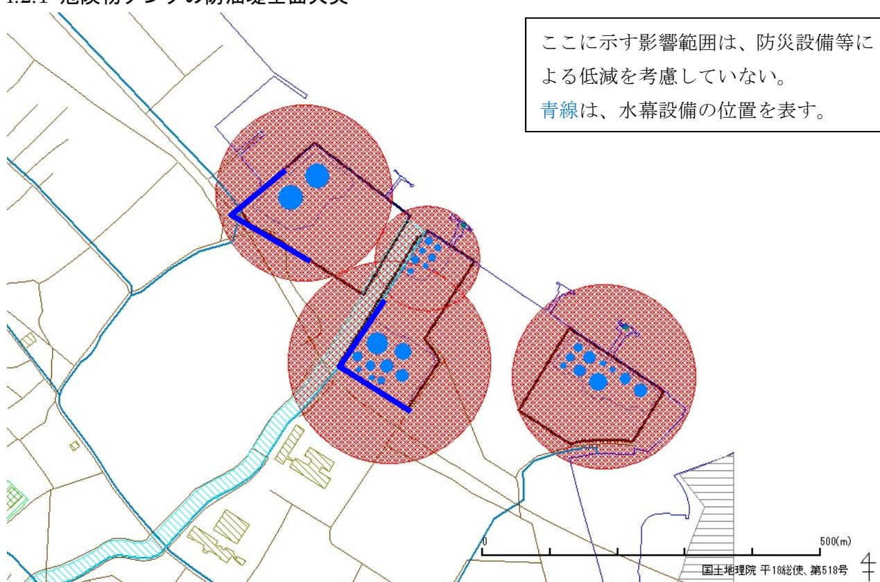
図 4.2.1 青森地区 危険物タンクの防油堤全面火災
