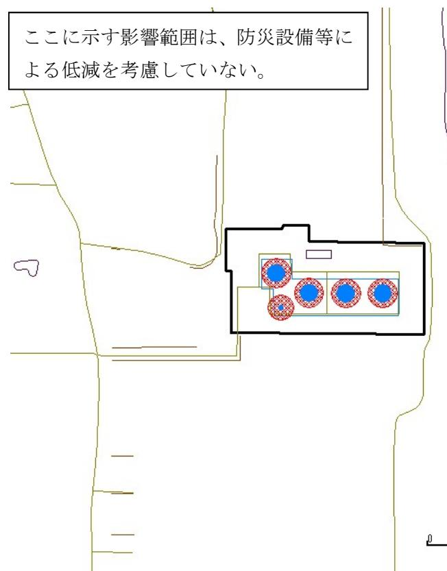
図 1.1.1 むつ小川原地区 危険物タンクの流出火災(平常時、発生危険度 A・B レベルの災害)
