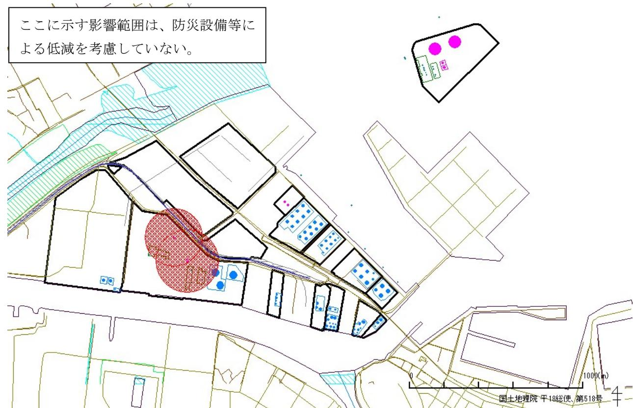
図 2.3.5 八戸地区 ガスタンクの毒性ガス拡散(短周期地震動、発生危険度 A~D レベルの災害)
