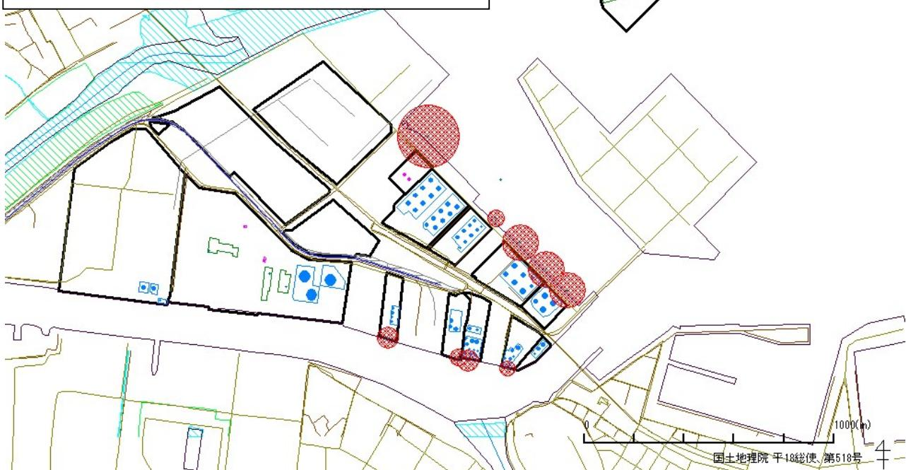
図 4.3.6 八戸地区 タンカー桟橋からの危険物の大規模流出による火災
