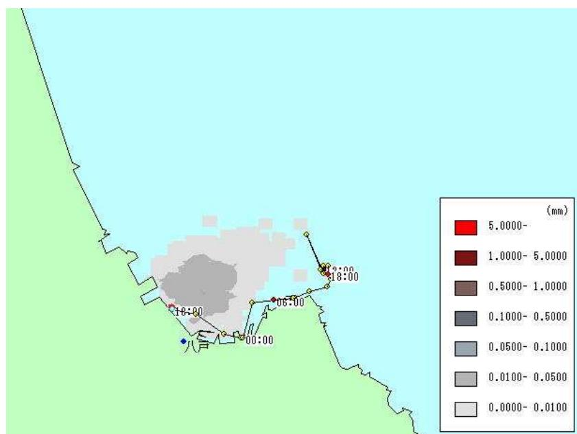
図 4.4.4 流出から 48 時間後の油膜厚の分布(タンカー桟橋からの大規模流出：八戸地区)
