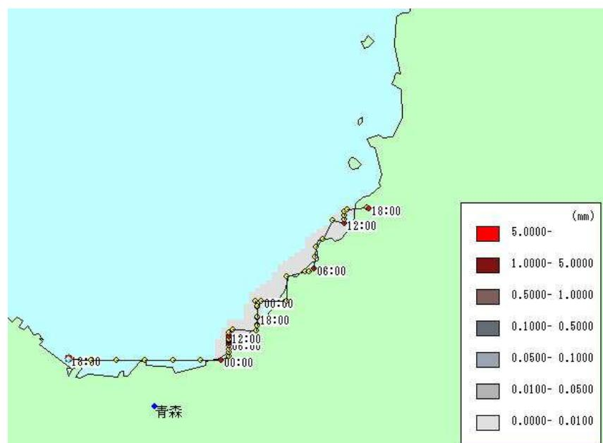
図 4.4.3 流出から 48 時間後の油膜厚の分布(タンカー桟橋からの大規模流出：青森地区)
