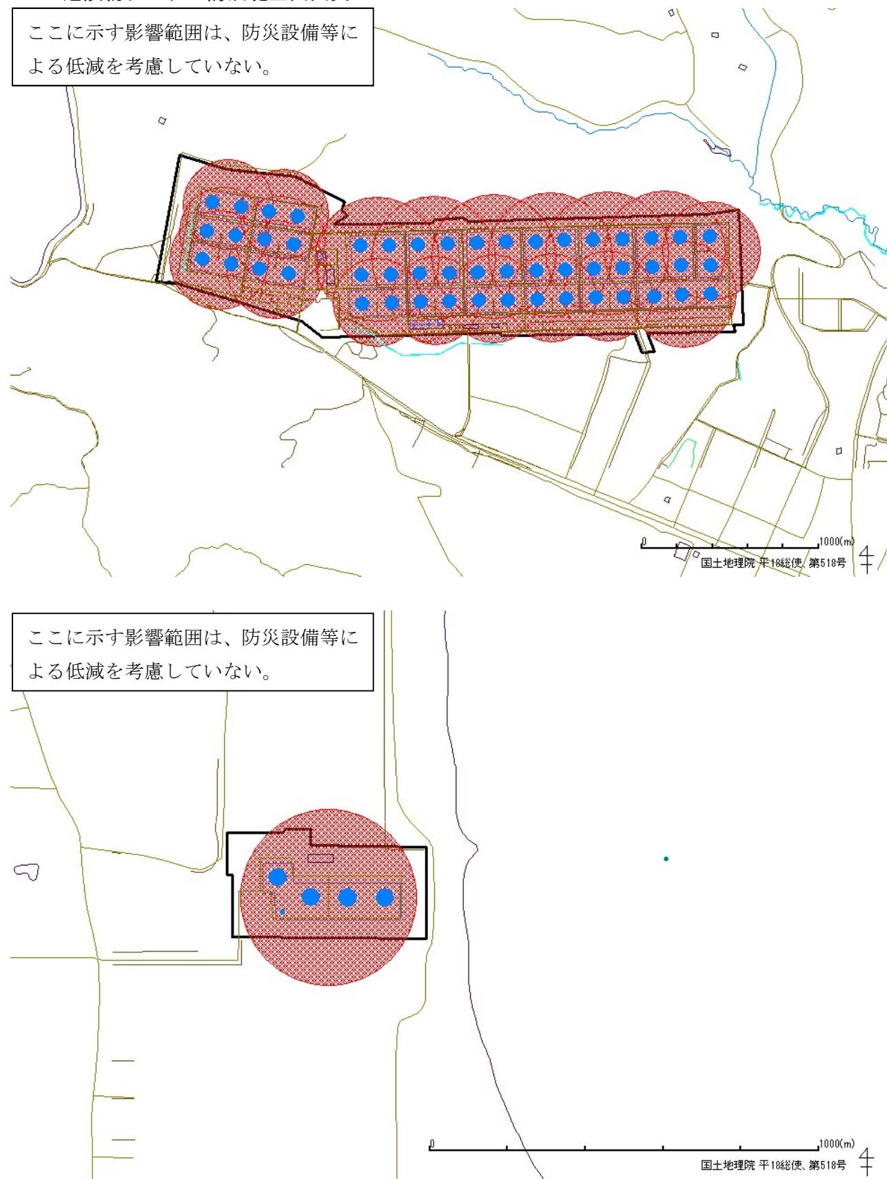
図 4.1.1 むつ小川原地区 危険物タンクの防油堤全面火災
