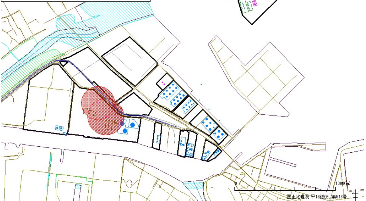
図 1.3.6 八戸地区 ガスタンクの毒性ガス拡散(平常時、発生危険度 A～C レベルの災害)
