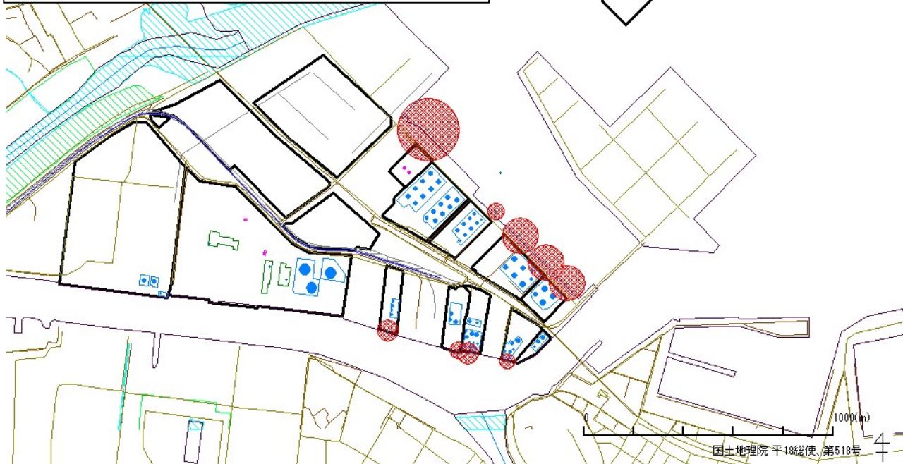
図 4.3.6 八戸地区 タンカー棧橋からの危険物の大規模流出による火災
