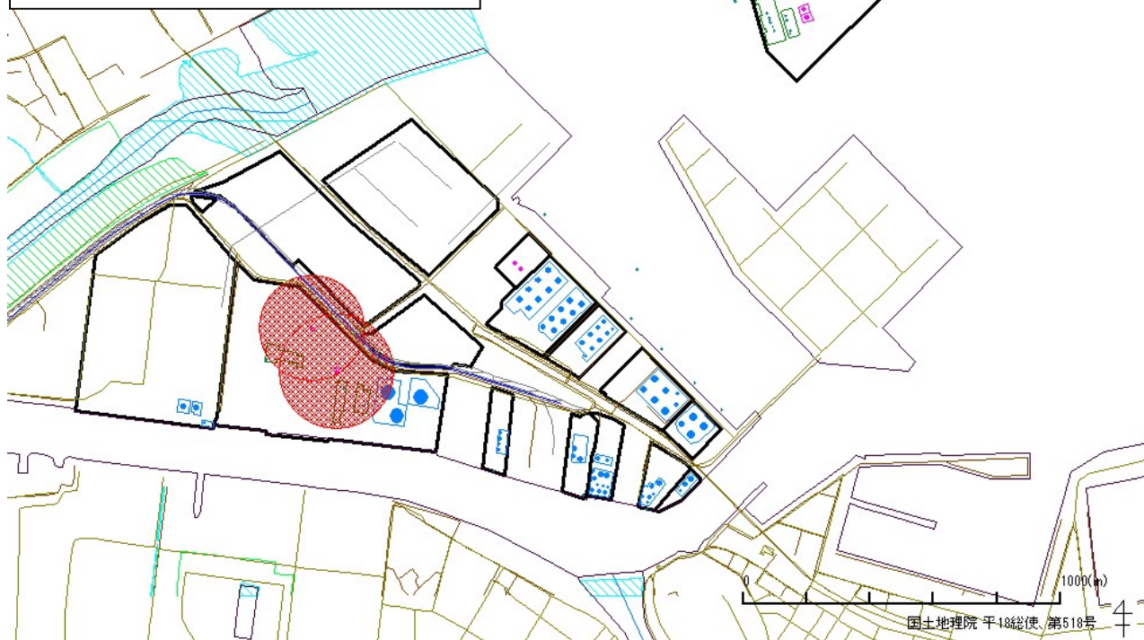
図 2.3.5 八戸地区 ガスタンクの毒性ガス拡散(短周期地震動、発生危険度 A~D レベルの災害)
