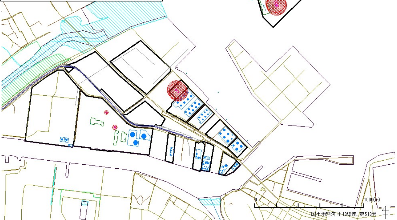
図 1.3.5 八戸地区 ガスタンクの爆発・火災(平常時、発生危険度 C レベルの災害)
