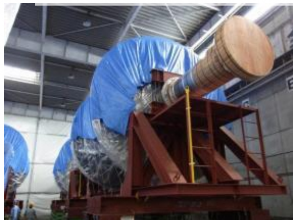
蒸気タービン
