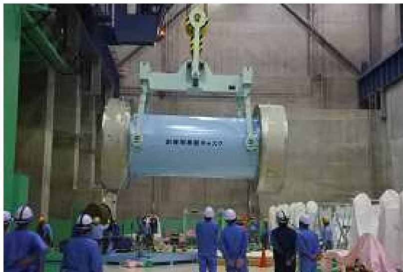
【横置き状態の金属キャスクを天井クレーンで取扱う訓練の様子】
