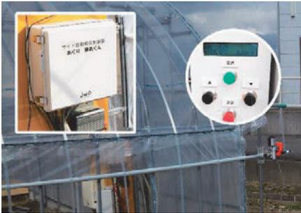
施設園芸ビニルハウスなどにおいて、パイプで側面のフィルムを巻き上げて開閉させる換気方法(サイド換気)を自動で行えるシステム。
