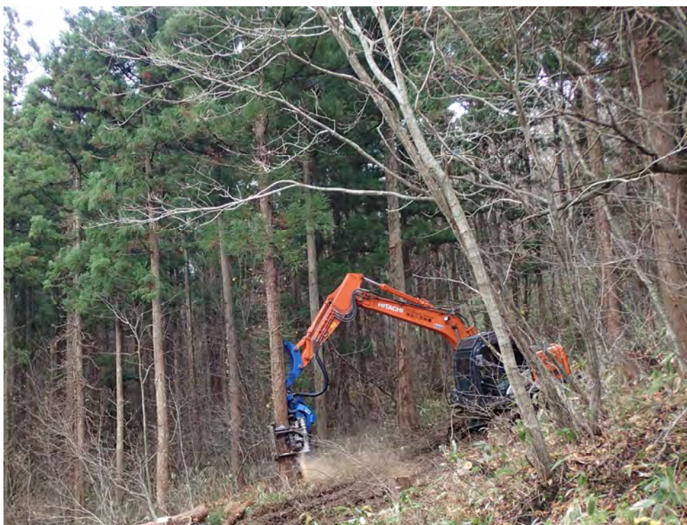
ハーベスタ（伐倒造材機械）による伐採作業 （東通村大字砂子又字大平滝地内）
