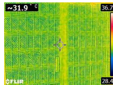
赤外線サーモグラフィー（右）によるシート 乾燥の状況（左：温度ムラがなく、適切な管理）
