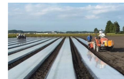
自動操舵トラクタによるにんにくのうね立てマルチ張り作業
