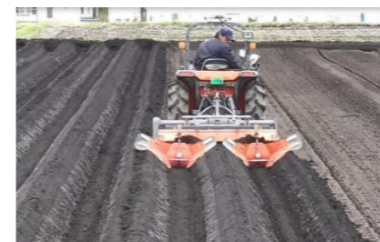
自動操舵トラクタによるネギの植え溝形成作業
