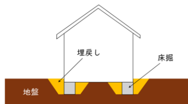
図 1.9.11 地中埋設物撤去のための床掘り及び埋戻し
