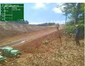
【TLS（地上型レーザースキャナー）測量】
