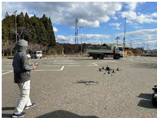
▽ UAVレーザ測量状況
