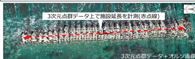
図-1 3次元計測からの施設延長の計測
