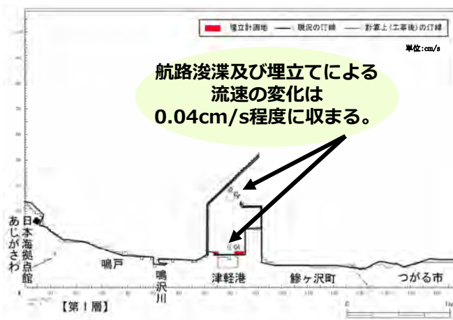
図-2 差流速図(将来流況－現況流況) (埋立前後の地形で予測、0～3m深の結果)
