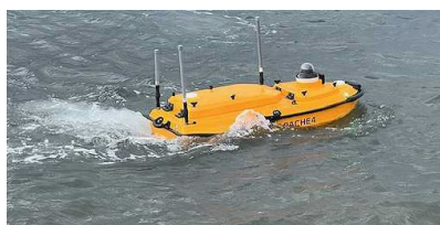
NMB深浅測量状況（GNSSソナー搭載無人ボート）
