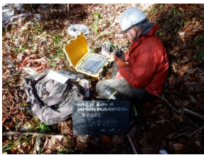
弾性波探査測定状況
