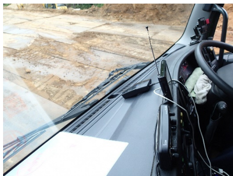
土砂運搬車両の運行管理(GPS及びアプリ使用によるリアルタイム走行履歴)
