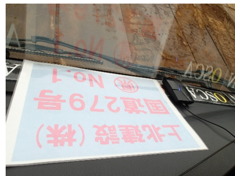
土砂運搬車両の運行管理(GPS及びアプリ使用によるリアルタイム走行履歴)
