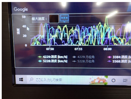
土砂運搬車両の運行管理(GPS及びアプリ使用によるリアルタイム走行履歴)
