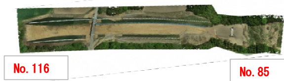
起工測量計測データ(オルソ画像)
