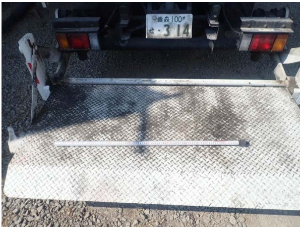
削孔長測定器具
