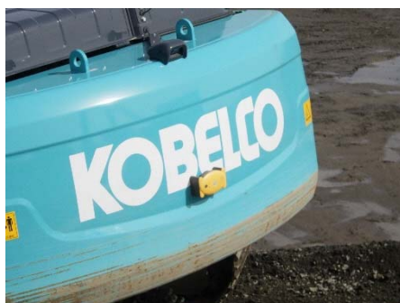
人感センサー式音声警報機装着状況
