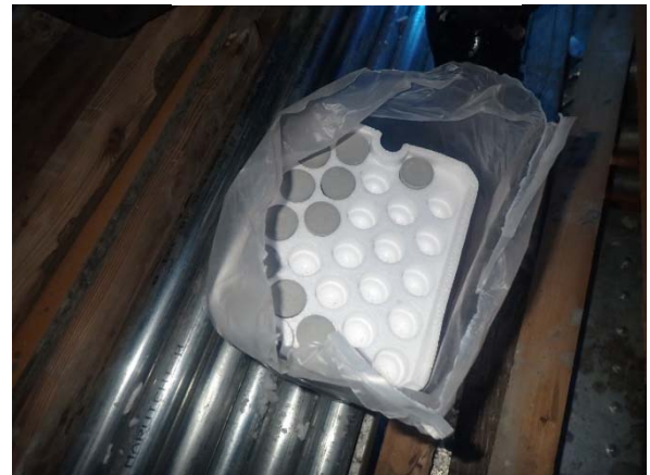
プレキャスト製補修材
