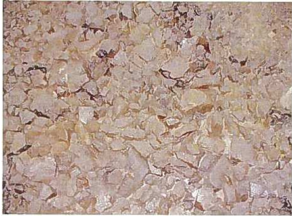
礫(碎石、ズリ)：トンネルズリや岩砕ズリの建設発生土で、礫主体で (第1種) 砂、粘性土の混入が非常に少ないもの。
