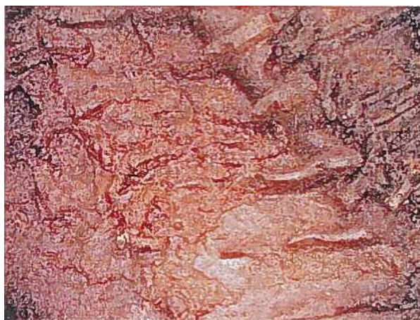
粘 性 土 : 粘性土が主体で常に軟らかい状態である。 (第4種) 手でさわると「ベタベタ」で、極めて軟らかい状態である。 ブルドーザーの走行が困難である。
