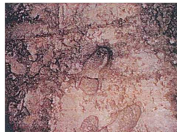
粘 性 土 : 粘性土が主体で常に軟らかい状態である。 (第4種) 手でさわると「ベタベタ」で、極めて軟らかい状態である。 ブルドーザーの走行が困難である。人が歩くと長靴がはまり込む。
