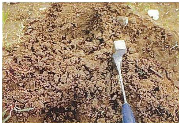
砂混じり粘性土 : 粘性土が主体であり、砂をいくらか含んだ手 (第4種) でさわると「ベタベタ」した状態であるが、指 ではざらざらした感じである。
