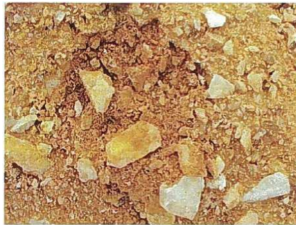
礫質土：一般に発生しやすい土砂で礫や砂。 (第2種) 粘性土がほぼ同量混じっているもの。 適度な湿り気を持っており、盛土材料としては扱い やすい。
