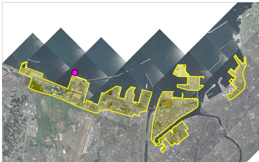
図-3.5 津波波形の出力地点(八戸港において津波到達時間が最も早い地点)
