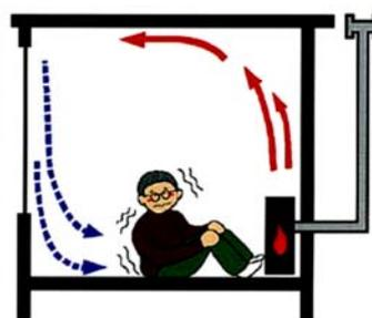
ダウンドラフトの仕組み
