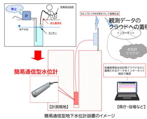
簡易通信型地下水位計設置のイメージ
