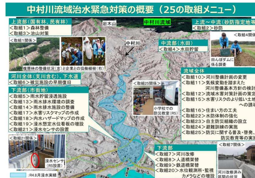
図 4-2 中村川流域治水緊急対策 (令和5年3月策定)
