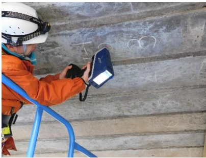
写真-3 蛍光X線分析での測定状況
