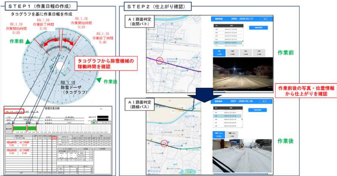
「図-1」フォローアップ体制の例（県道鶴ヶ坂千刈線：令和8年1月18日）
