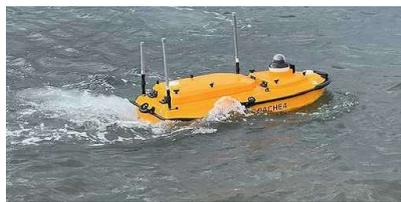
NMB深浅測量状況（GNSSソナー搭載無人ボート）
