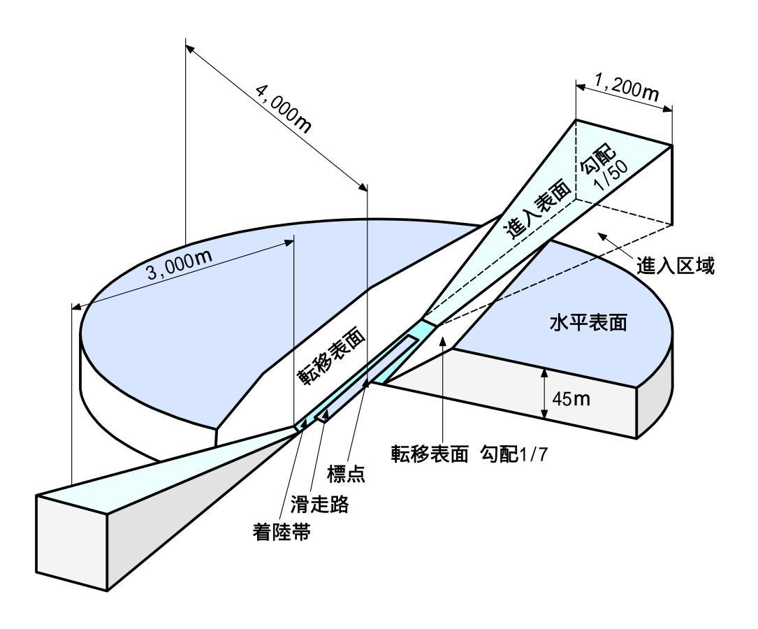
制限表面 …航空機の安全運航を確保するため、空港及びその周辺に設けられた 障害物を制限する表面
