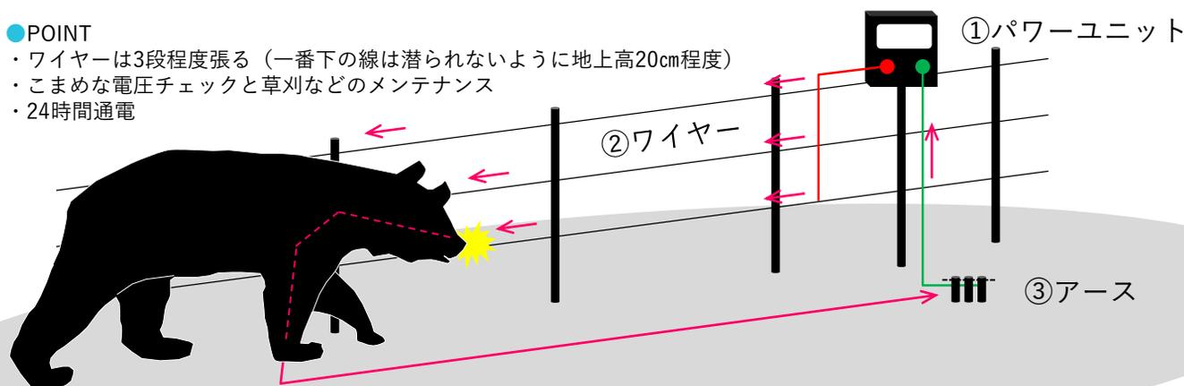
ワイヤーには、①パワーユニットから電気が流れています。クマの鼻先が②ワイヤーに触れるとクマの体を伝って、地面に電気が流れます。その電気を③アースが回収することで、電気の回路が成立します。（地面を通じてクマとアースの間を電流が流れることで感電します。）
