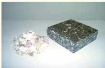
ホタテ貝殻を骨材の一部として再利用したアスファルト混合物です。通常製品と同等の品質を有しています。
