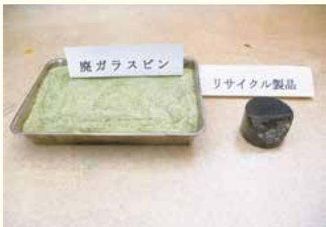
廃ガラス、アスファルトコンクリート塊を使用した再生加熱アスファルト混合物です。
