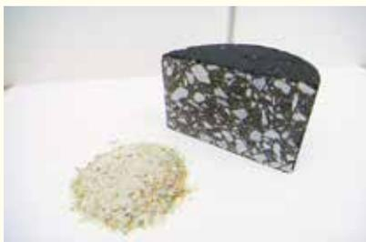
廃ガラス、アスファルトコンクリート塊を使用した再生加熱アスファルト混合物です。通常製品と同等の品質を有しています。
