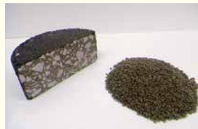
一般廃棄物溶融スラグ、アスファルトコンクリート塊を使用した再生加熱アスファルト混合物です。通常製品と同等の品質を有しています。
