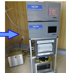
常時監視測定局内の 大気汚染自動測定機
