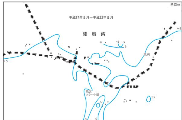
図2-4-11 青森地区地盤沈下等量線図（累積）
