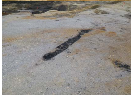
⑨南西側の火山礫層分布状況 炭化木あり→火砕流堆積物
