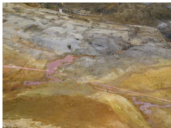
⑥ア-43付近の地質分布 軽石質火山礫が広く分布 高透水性→帯水層 （地下水の染み出しあり（褐色部））
