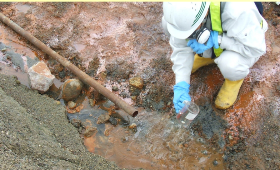
現場内湧水採水の様子
