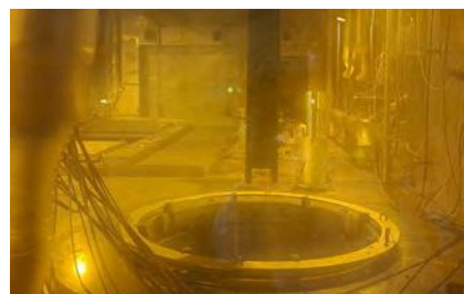
乾式キャスクから使用済燃料の集合体を取り出す様子
