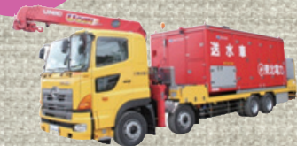
送水車(代替非常用冷却海水ポンプ)
