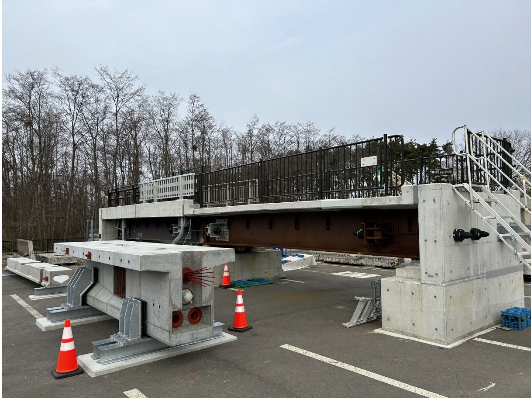
実橋モデル(奥)とプレストレストコンクリート(PC)桁(手前)
