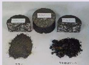
一般廃棄物溶融スラグ、アスファルトコンクリート塊を使用した再生常温アスファルト混合物です。
