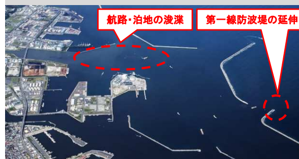
航路・泊地の水深確保と第一線 防波堤の整備促進 【八戸港】
