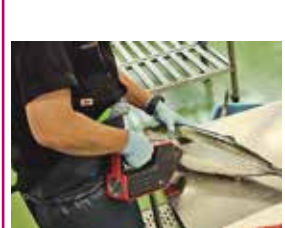
非破壊計測によるブリの脂質測定
