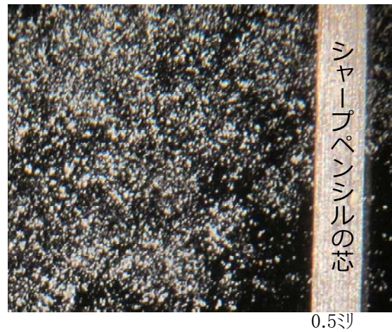
図3 DL (ドリフトレス) 粉剤の拡大写真
