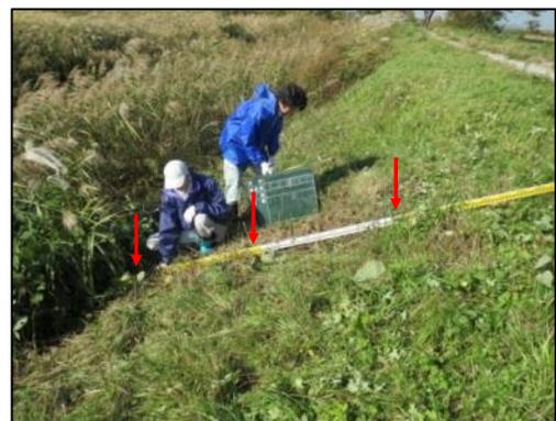
写真に示す赤矢印の位置に杭を打ち、その間隔を測り、記録ましよう。
