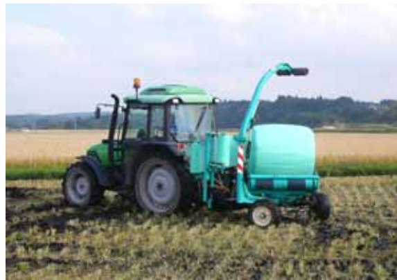
収穫した稲ロールのラッピング作業
