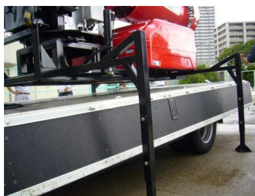
(自立のための脚を装着 発生現場等で重機を使用せずに除染機を他のトラックに載せ替え可)
