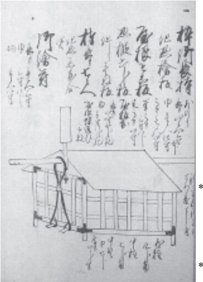
*2 *1 「鉄金物鎖前付 外柱 九分角 中貫 巾七分 厚サ 貳分半」 どの台とら付 中柱 七分角
