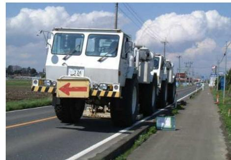
反射法地震探査で使用する起震車 (イメージ)
