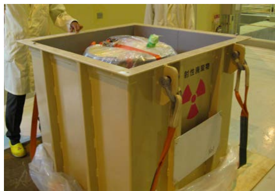
写真3 1m³容器（オーバークラップ容器）内に200Lドラム缶を収納した状況
