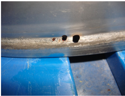
写真1 300Lステンレス製ドラム缶側面底部からの漏えい発見当時の状況
