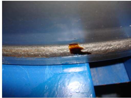
写真1 300Lステンレス製ドラム缶側面底部からの漏えい発見当時の状況
